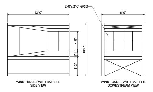
FIGURE 2 WIND DRIVEN RAIN WIND TUNNEL
