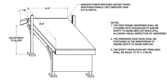
FIGURE 1A WIND DRIVEN RAIN TEST FRAME, FRONT VIEW
