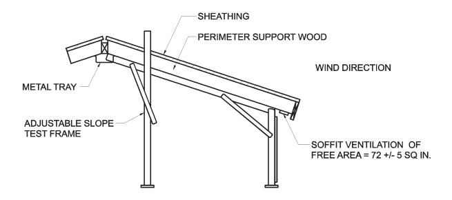
FIGURE 1B WIND DRIVEN RAIN TEST FRAME, SIDE VIEW
